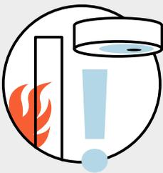
der Raum durch Unterzüge an der Decke oder durch andere Hindernisse so unterteilt ist, dass dadurch die Rauchausbreitung zum Rauchmelder behindert werden kann,
